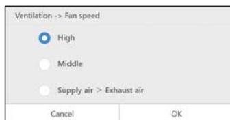
Vous pouvez régler la vitesse du ventilateur raccordé à l'échangeur de chaleur air/air ou au climatiseur. Les choix affichés dépendent du modèle.
