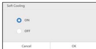
REFROIDISSEMENT moyen peut être DÉMARRER/ARRÊTER. Lorsqu'il est DÉMARRÉ, la direction de l'air est réglé vers le haut, et la puissance maximale est limitée.
