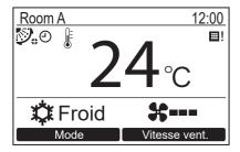
Nettoyez le filtre à air quand "⊞! " (icône du filtre) apparaît sur l'affichage détaillé. (page 22) ("⊞! " n'est pas affiché en mode d'affichage normal.)
